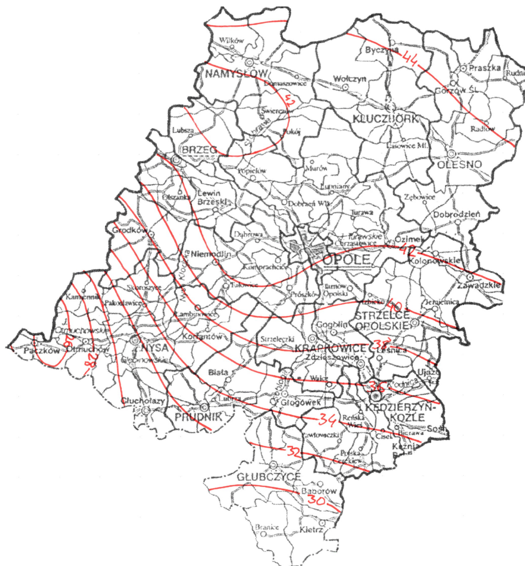
Rys.2. Mapa temperatur skał dla województwa opolskiego na głębokości 1000 m pod poziomem morza
